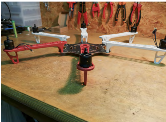
Figura 2. Muntatge del bastidor, els braços i el motor del dron. Font: Martínez, Pérez i Viñallonga.
